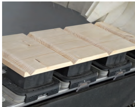
/ ... sind also auch bei Vollholz quer zur Faser kein Problem, wie unsere Tests unter Beweis gestellt haben. Und das auch bei einem Ast im Endbereich.
