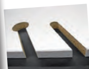
/ Eine Folge des P-System-Fräses von außen mit voller Tiefe in das Werkstück hinein (1) bzw. heraus (2) in beiden Fällen blieb die Kante völlig unversehrt.
