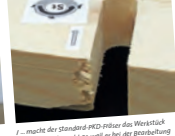
/ ... machte der Standard-PKD-Fräser das Werkstück im Prinzip unbrauchbar, weil es bei der Bearbeitung extrem starke Ausrisse verursachte.
