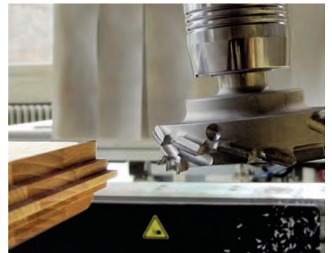
/ In diesem Buchenhirnholz waren abgestufte Fälze aus dekorativen Gründen gefragt. Die Oberfläche ist auch ohne Schliff lackierfähig.
